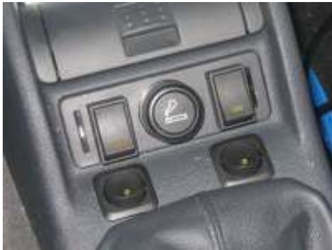
Die Schalter.... Zuerst hatten wir andere, die mehr Leuchtfläche hatten, jedoch auf Dauer ziemlich hässlich waren. Siehe weiter unten... Später haben wir uns dann diese schwarzen mit Leuchtdiode geholt.
