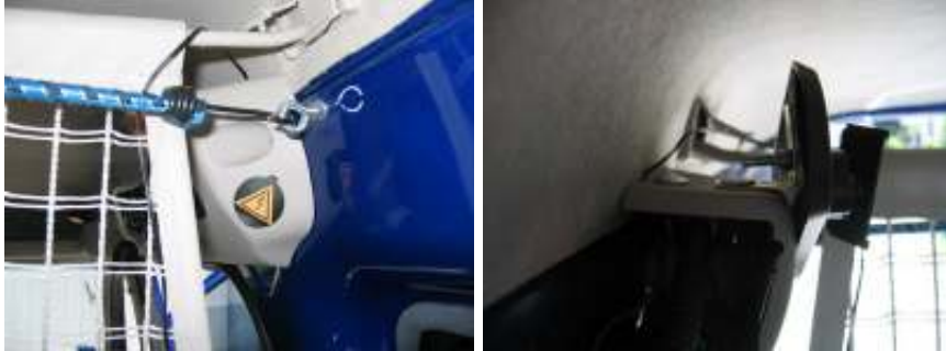
Eine von den beiden Steckdosen und der Befestigungswinkel für die Lüfter.
